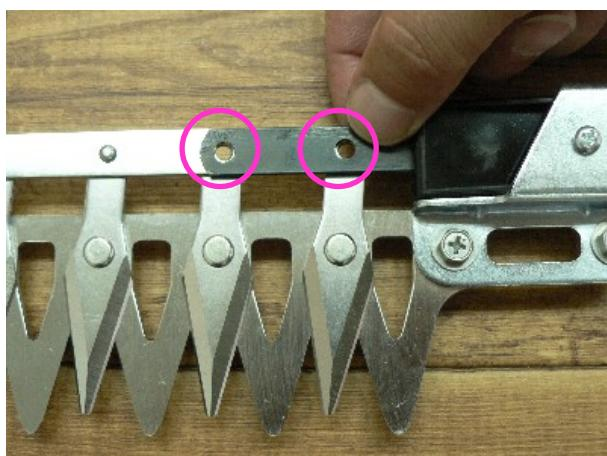
**8.可動刃取付けネジ・ナットを取り付ける**
