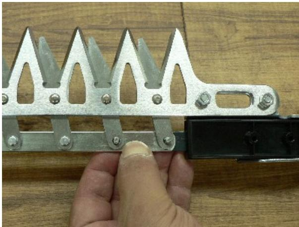
ネジが抜け落ちないように、指で押さえながら、刃を裏側に向けます。
