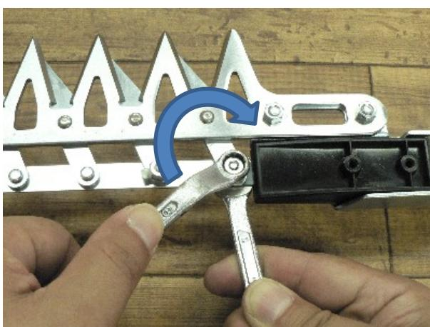
ネジをレンチで抑え、ナットをもう 1 つのレンチ(もしくはスパナ)で締め付けます(2箇所)。
