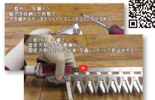
鋸や替刃商品などの替刃交換方法を動画で確認していただけます。手順の流れや細かなポイントを確認しながら替刃を交換していただけます。
