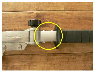
7. 刃側のパイプ固定ネジを取り外し、パイプ部分を引き抜く
