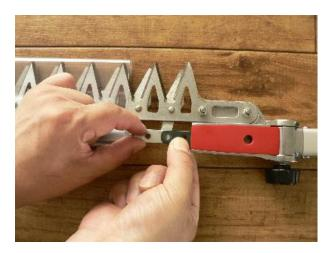
可動刃は刃先側へずらすようにし、板ロッド棒はモーター側へずらすように動かしてください。
