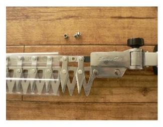
ナットは回して外し、ネジは抜き取ります。
