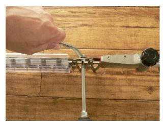
レンチ(もしくはスパナ)が 1 本しかない場合は、ネジをプラスドライバーで抑え、ナットをレンチ(もしくはスパナ)でゆるめます。
