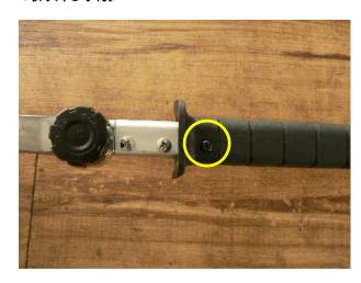
1. 中間グリップ固定ネジを取り外す 中間グリップ固定ネジを取り外します(1本)。 ※プラスドライバー
