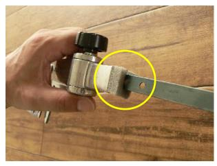
5. 板ロッド棒・パイプをネック部にセットする ネック部のスポンジの間を通してください。
